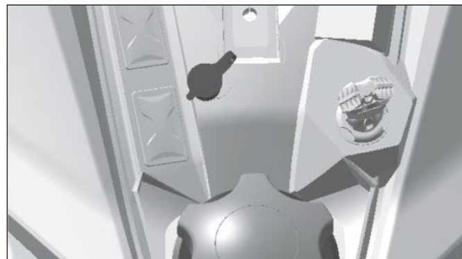
Расположение разъема электрообогрева стекла шлема
