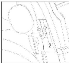
1. Сливной бачок корпуса воздушного фильтра с чистой зоны.
