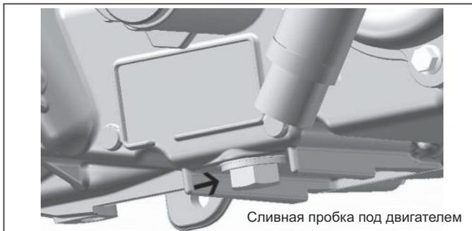
Сливная пробка под двигателем
