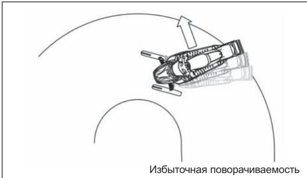
В определенных условиях использование более жестких твердосплавных полозьев без шипов на задней гусенице может привести к тому, что снегоход будет демонстрировать избыточную поворачиваемость, см. рисунок.
