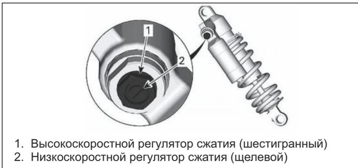
Низкоскоростное демпфирование сжатия контролирует реакцию амортизатора на медленные ходы сжатия, в большинстве случаев при езде на низких скоростях.
