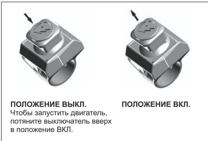
Каждый водитель снегохода должен ознакомиться с функцией аварийного выключателя двигателя и использовать ее несколько раз при первой поездке и далее при каждой остановке двигателя, чтобы понять процедуру остановки двигателя и быть готовыми к аварийным ситуациям, требующим использования выключателя.
