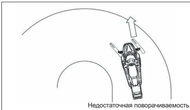
В определенных условиях использование шипов на гусенице может привести к недостаточной поворачиваемости снегохода, если лыжи не оснащены более жесткими твердосплавными полозьями, см. рисунок.
